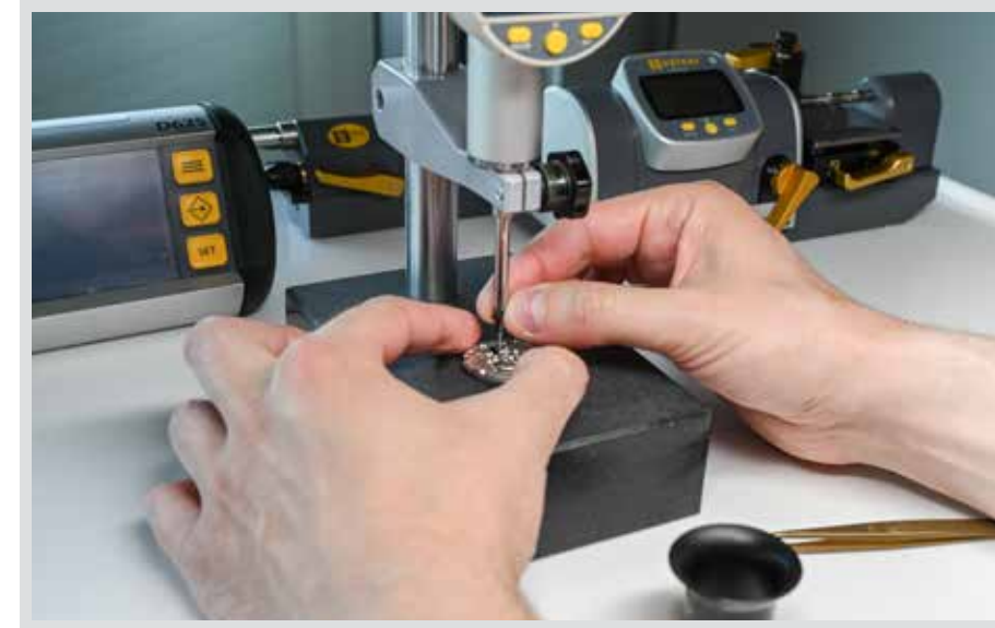
Mätning av en klockkomponent med en S_Dial PRO Smart
