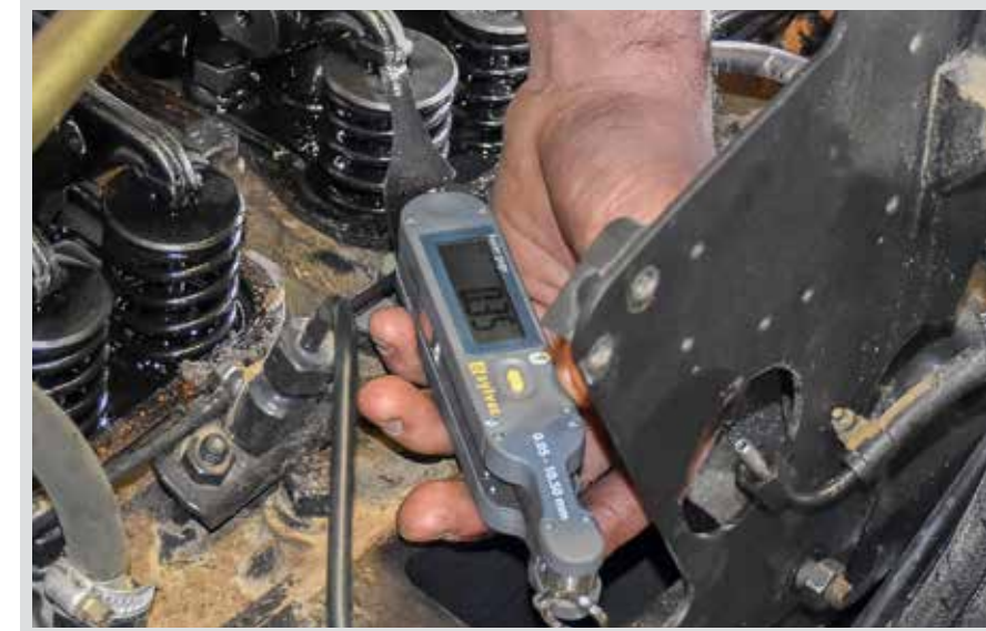
Mätning av ventiler med Feeler Gage Smart
