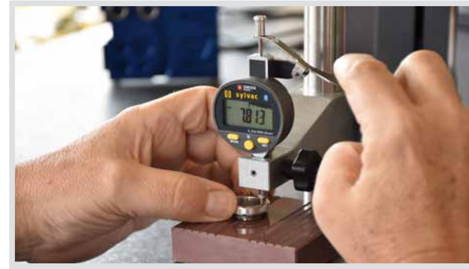
Mätning av detalj med en S_Dial MINI Smart
