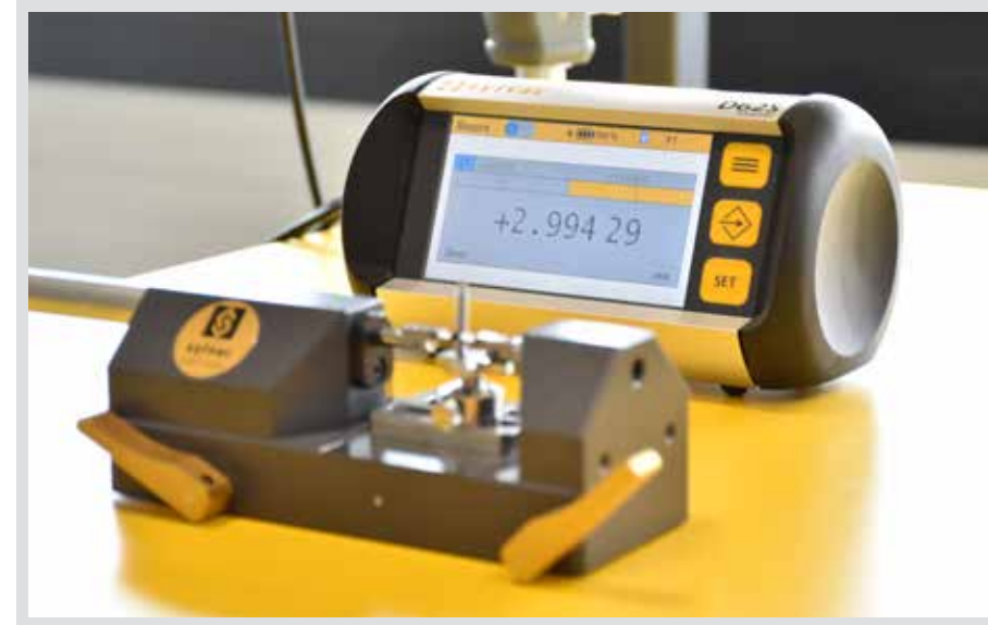
P12D mätgivare monterad på en PS15 mätbänk och ansluten till D62S Advanced enhet.
